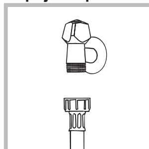
1. Pripojte prívodnú hadicu jej zaskrutkováním ku kohútiku so studenou vodou s hrndlom so závitom 3/4" (viď obrázok). Pred pripojením hadice nechajte vodu odtieť, až kým nebudete círa.
